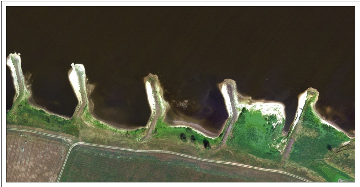
Abb. 7-29: Luftbild der versuchsweise erstellten Knickbuhnen am Elbe-km 440 und 441 (August 2003); Fließrichtung von rechts nach links (Foto: BfG)
