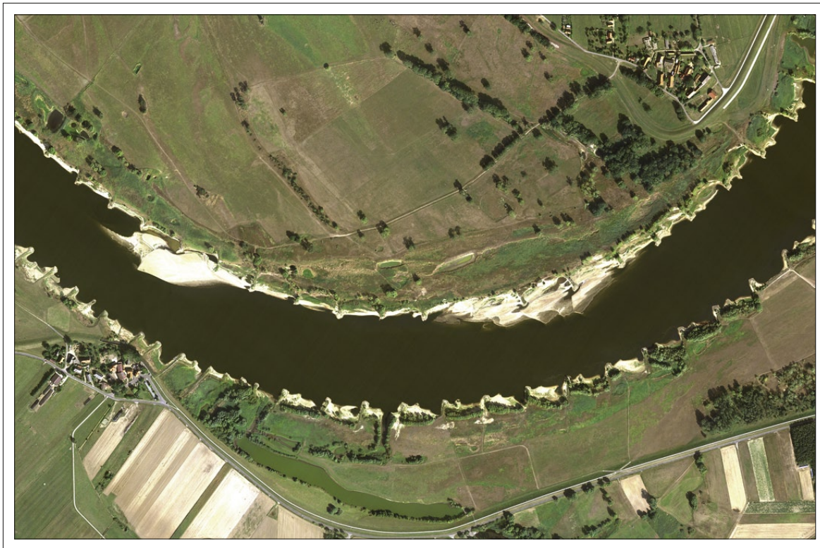
Abb. 7-30: Luftbild des Elbabschnittes bei Elbe-km 518 bis 520 (südlich von Hitzacker) mit großen Transportkörpern (Sandbänken und -dünen) (Foto: BfG)
